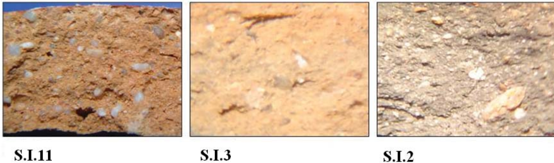
Fig. 6- Osservazioni allo stereomicroscopio, 10 e 15X. Nelle tre immagini si osservano gli impasti di campioni appartenenti rispettivamente al gruppo 1, 2 e 3.
